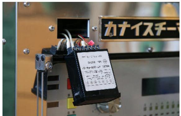
温度計表示ユニットの取り出し完了！
